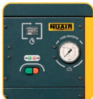
El panel de instrumentos que incluye todos los testigos necesarios para el funcionamiento de la máquina, está instalado de modo que permite su fácil lectura. Las versiones con arranque estrella-triángulo llevan un panel electrónico con testigos que señalan las posibles anomalías
